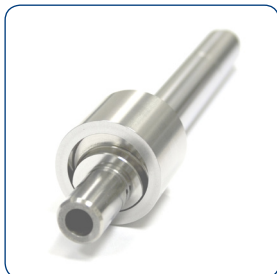
ベアリングとクランクシャフト: 真円度、真直度、平面度<3μm、 同心度<8μm、直角度<5μm
